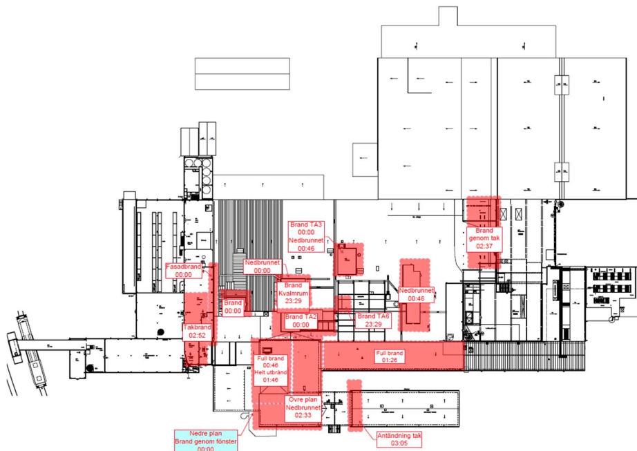
Bild 13: Översikt bild brandförlopp på taket. Se även bilaga 3
